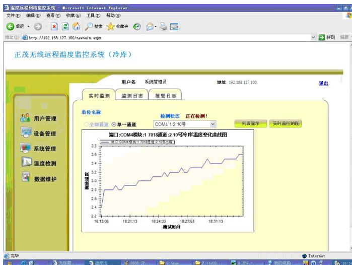
设定管理权限的所有监控冷库运行状态列表实时显示，一目了然。重点关注某个冷库间运行状态，也可选用图形曲线方式。
